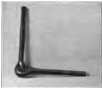
FIG. 47. DOUBLE EYE BOLT.
