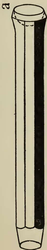
Fig. 56. The rivet snap.
